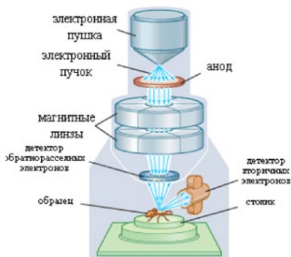
Рис. 112. Принципиальная схема сканирующего электронного микроскопа
